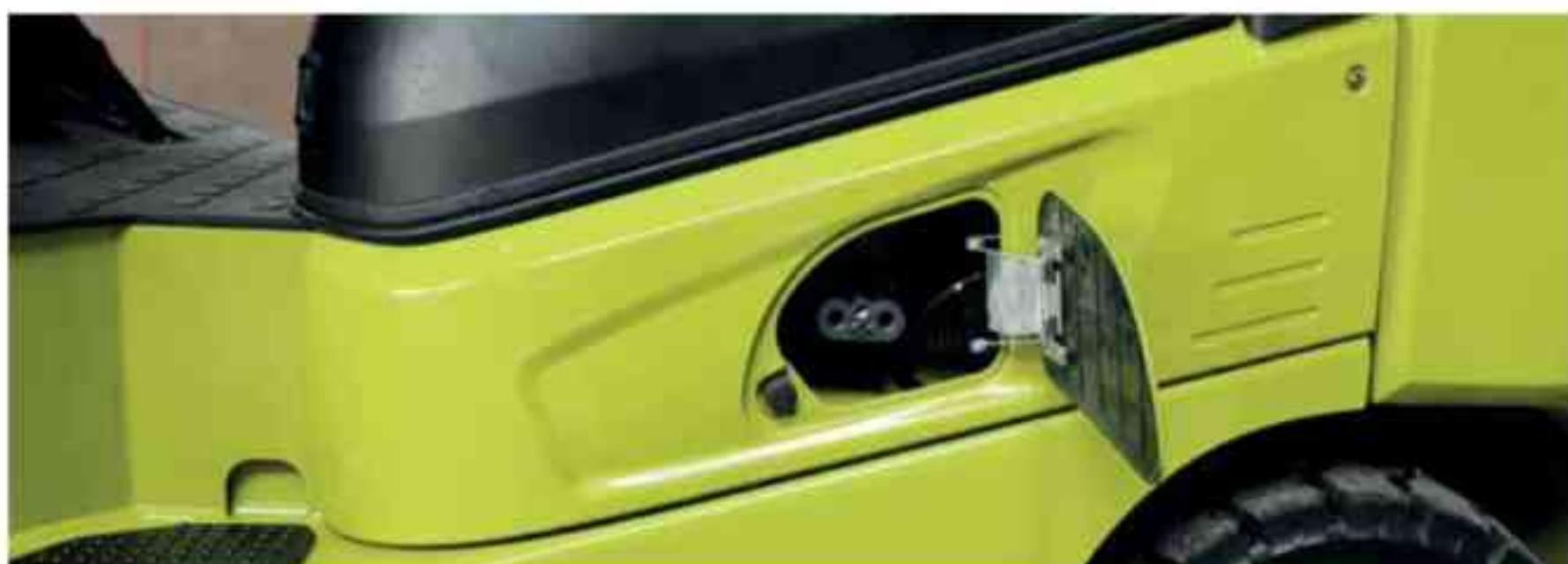
La batería de iones de litio puede recargarse cómodamente a través de una tapa lateral sin tener que abrir la tapa de la batería.
