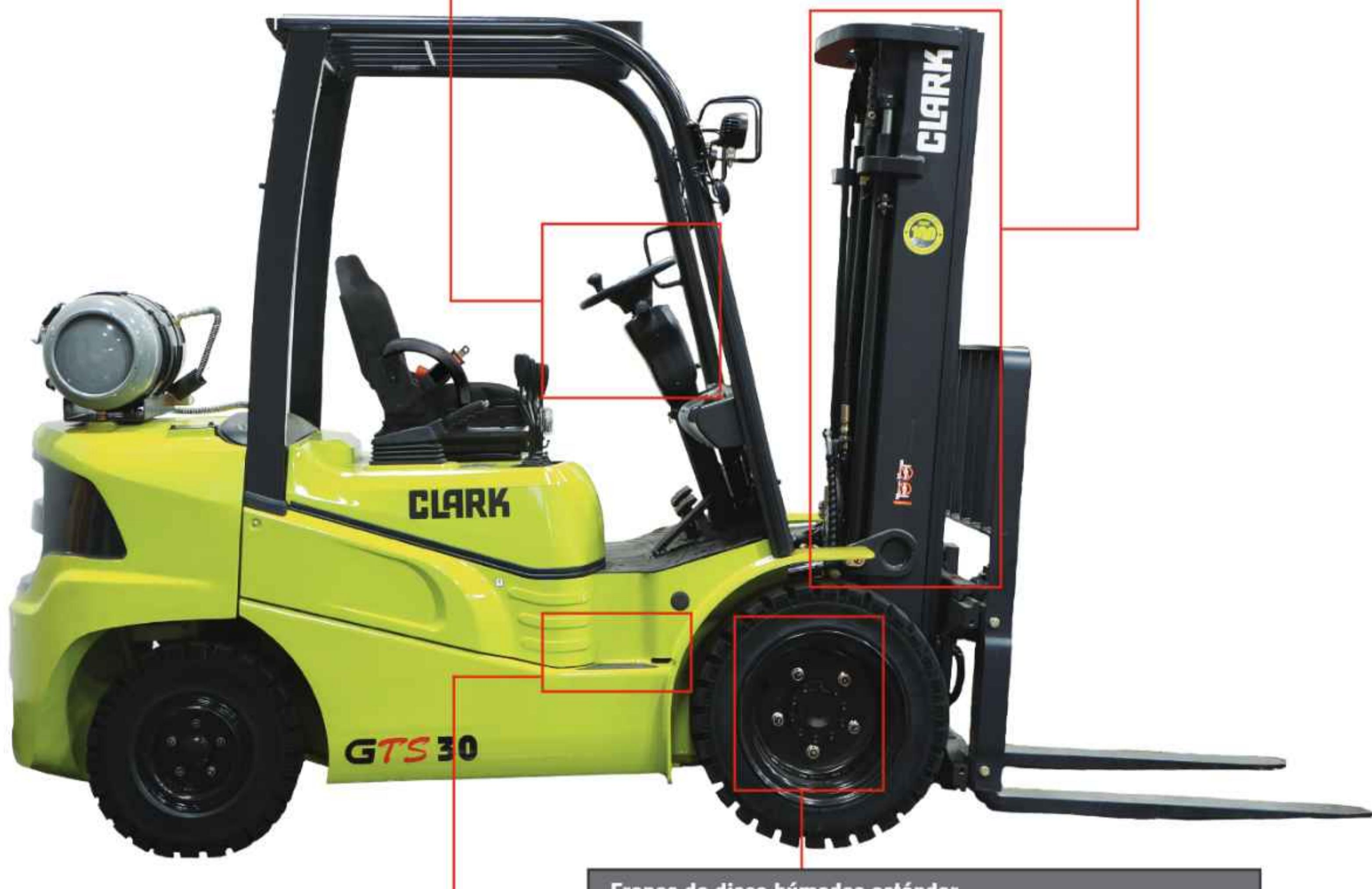
El conductor accede al compartimento de diseño ergonómico a través de un escalón de metal antideslizante grande, bajo y perforado.
