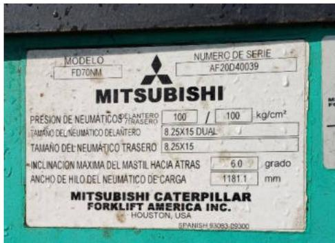
Placa Interior y Horómetro
